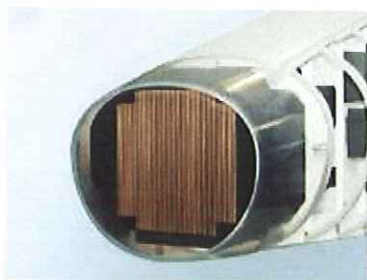
Vixen-E radar da combattimento a scansione elettronica
