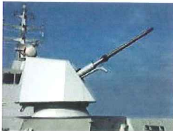
Cannoni navali di medio calibro da 76mm per navi di superficie di qualsiasi categoria con capacità duale anti-aerea ed antinave
